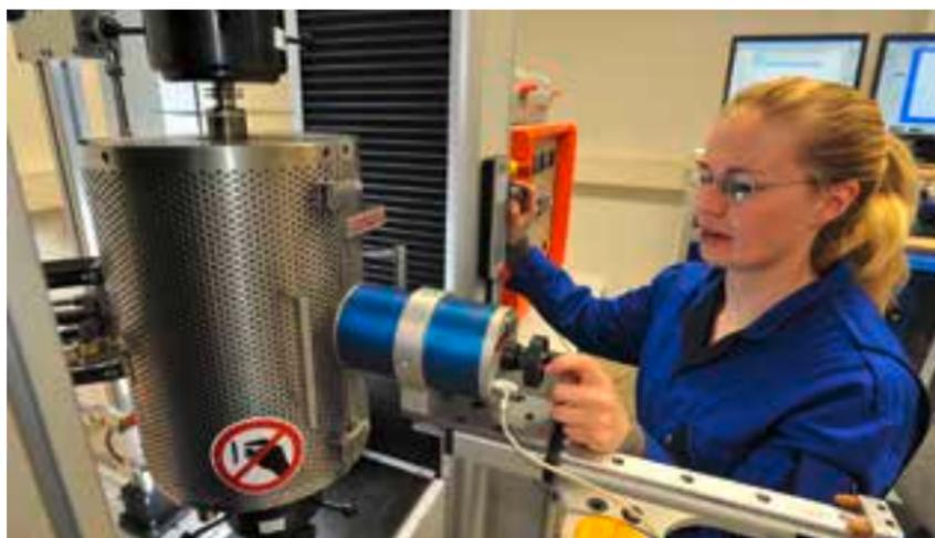
Kennwertermittlung für Bor-Mangan-Stähle durch Warmzugversuche
