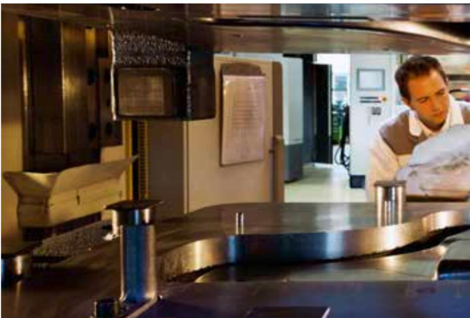
Herstellung eines B-Säulenfußes durch Presshärten
